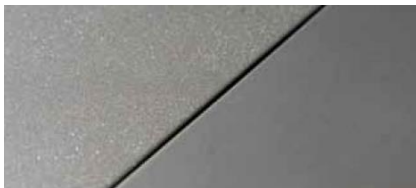
Rechts: behandeld met het waterstraal proces Links: behandeld met conventioneel parestralen
