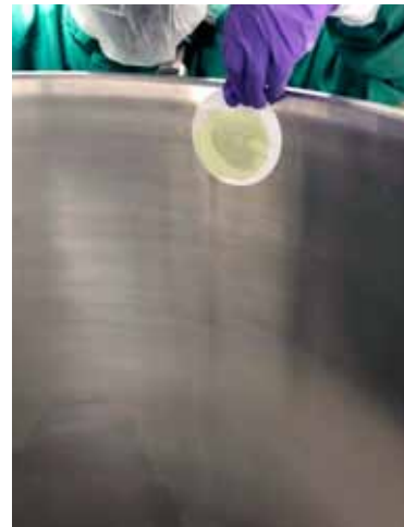
Figuur 2: Uitvoering van een passiviteitstest na reiniging. Een waarde hoger dan 60 bewijst dat het RVS oppervlak weer volledig passief (en dus beschermd) is.
