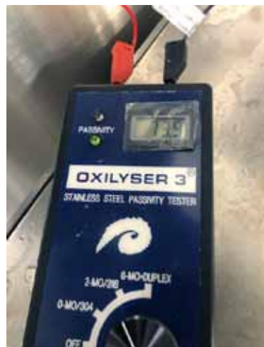
Figuur 2: Uitvoering van een passiviteitstest na reiniging. Een waarde hoger dan 60 bewijst dat het RVS oppervlak weer volledig passief (en dus beschermd) is.
