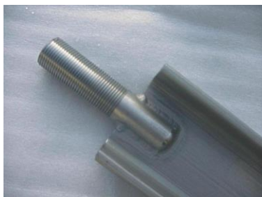
Links: een RVS goot met de typische lasverkleuring. Rechts: middels een beitsbehandeling is de lasverkleuring verwijderd waardoor de corrosiebestendigheid volledig is hersteld
