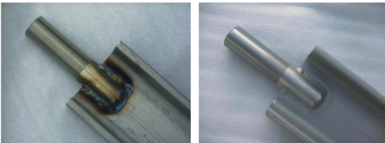
Links: een RVS goot met de typische lasverkleuring. Rechts: middels een beitsbehandeling is de lasverkleuring verwijderd waardoor de corrosiebestendigheid volledig is hersteld
